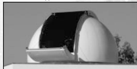
Astro-Kuppeln sind mehrteilige, verwindungssteife und formschöne Kuppelkonstruktionen aus Glasfaser-Polyesterkunststoff mit einem Kopfüber-Schiebetor und einer Ausstell-Horizontklappe (Größen ab 5m können alternativ mit seitlich verschiebbaren Toren hergestellt werden – wie zB. „Mount Palomar“).
