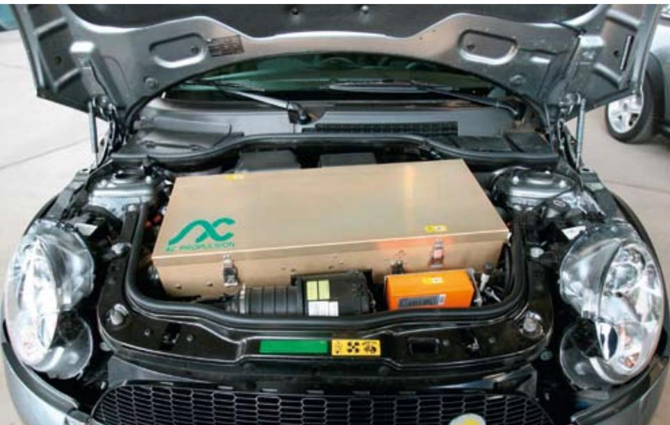
Einen ungewöhnlichen Anblick bietet der kastenförmige Elektromotor des Mini E. 150 Kilowatt leistet das Aggregat und beschleunigt den Zweisitzer in 8,5 Sekunden von null auf 100 Kilometer pro Stunde. Die Reichweite liegt bei 240 Kilometern. 500 Exemplare sind bereits im Pilotprojekt auf amerikanischen Straßen unterwegs, weitere 50 fahren bald durch Berlin. Der Lithiumionen-Akku ist im Fond des Wagens platziert.
