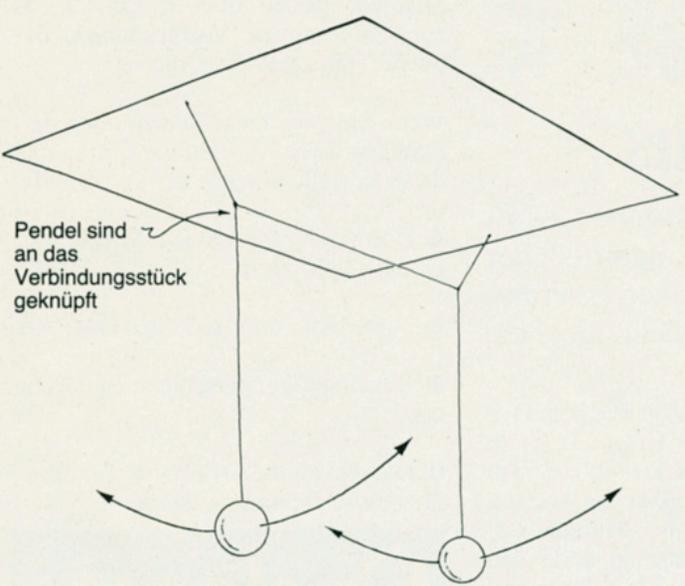
**Bild 3: Fadenkopplung.**
