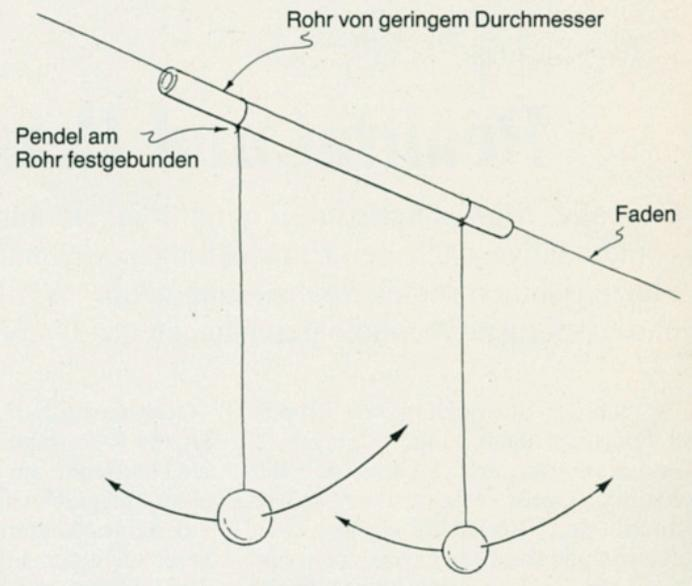
**Bild 4: Rohrkopplung.**
