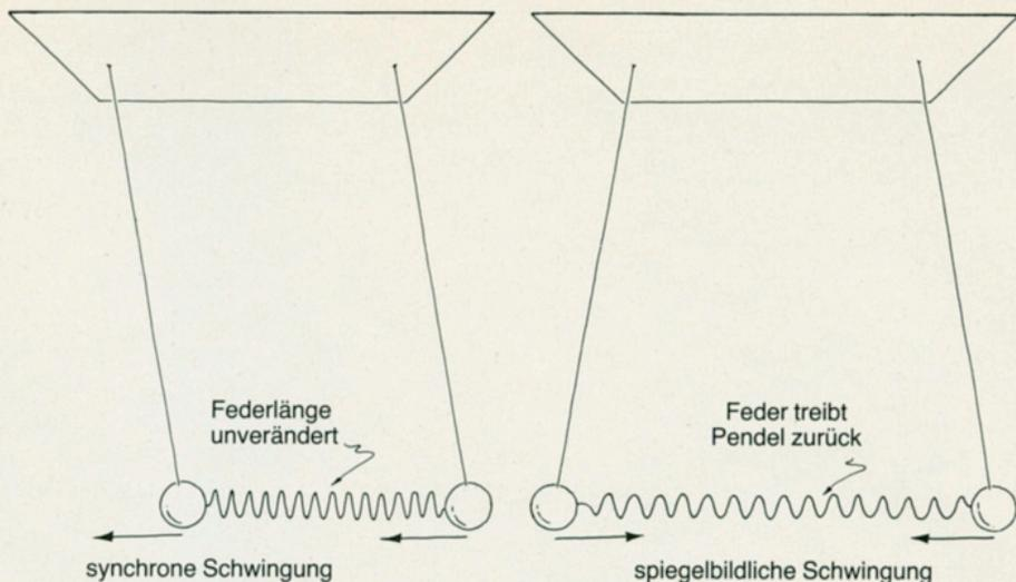
Bild 7: Normalschwingungen eines federgekoppelten Pendels.
