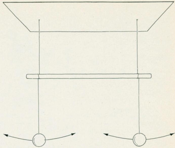
**Bild 2: Stabkopplung.**
