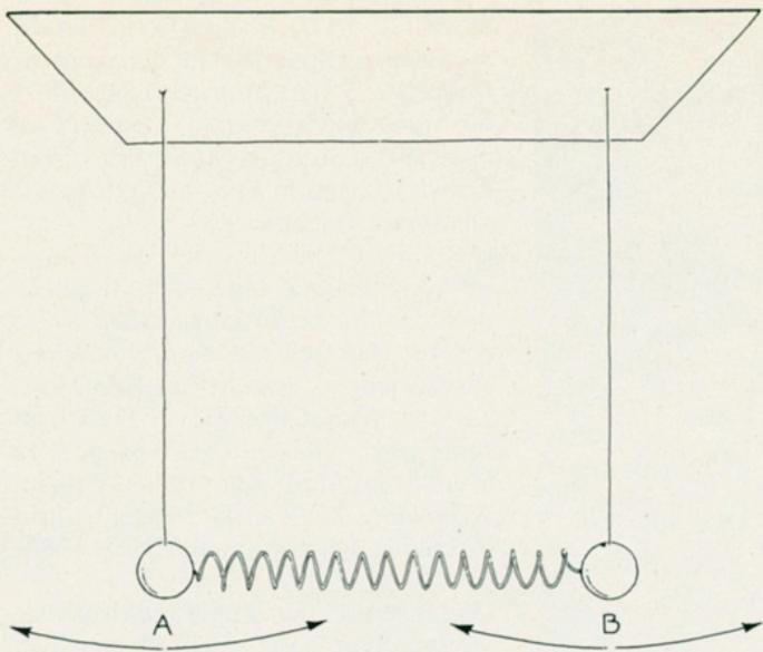
**Bild 1: Federkopplung bei Pendeln.**
