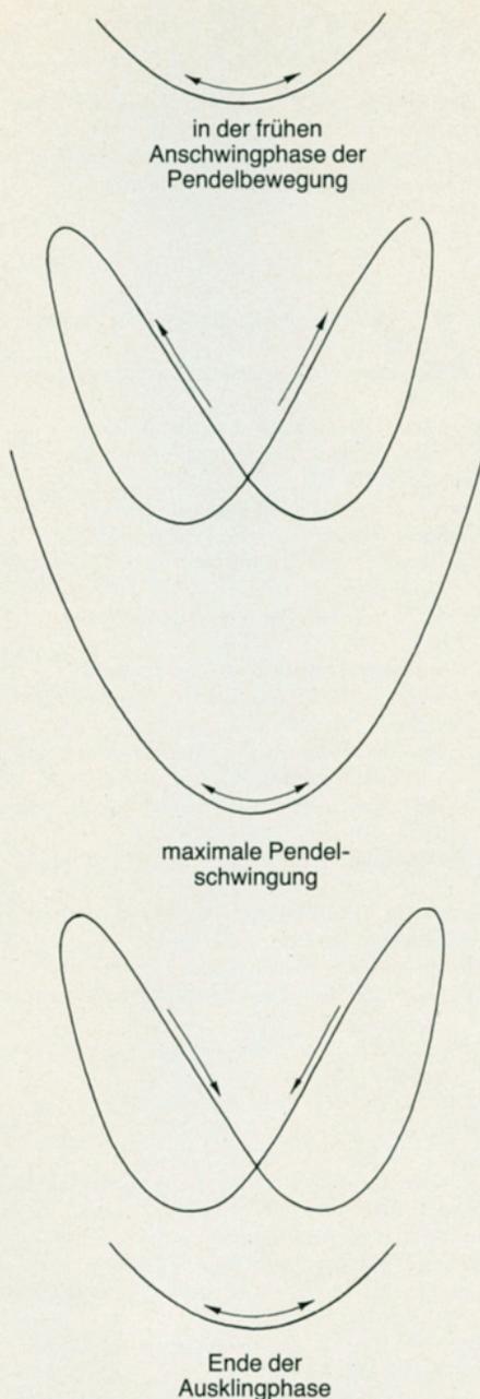
Bild 11: Lissajous-Figuren eines Pendels.
