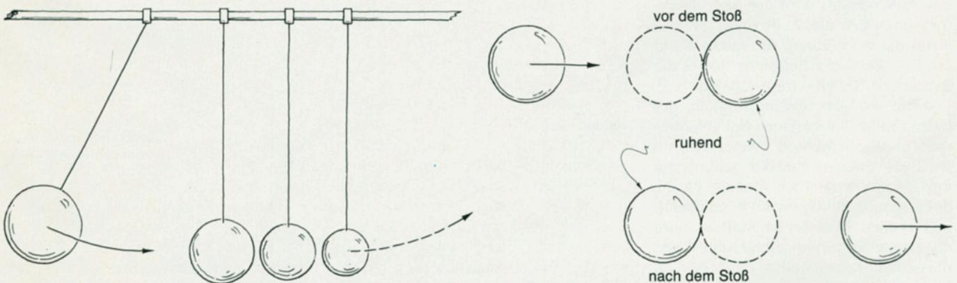
Bild 2: Eine Pendelmaschine für Stoßuntersuchungen (links) und ein Stoß zwischen gleichgroßen Massen.
