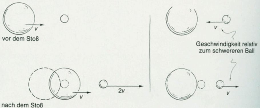
Bild 4: Stoß zwischen einem schweren und einem leichten Ball.
