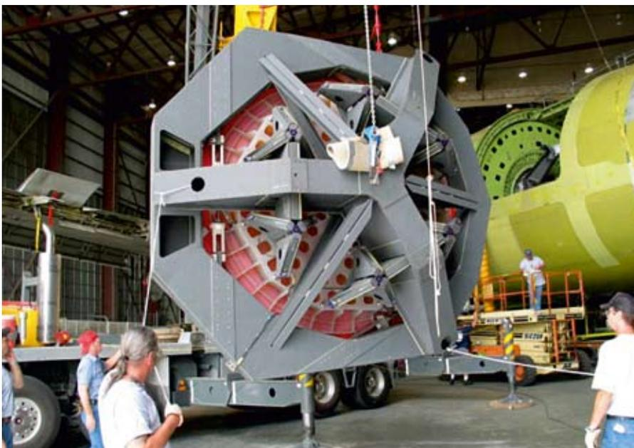
Der 2,7 Meter große Primärspiegel mitsamt seiner Zelle wird ins Flugzeug eingebaut. Der Spiegel selbst mit seiner weißlichen Honigwabenstruktur ist von der Rückseite her zu erkennen, die rote Farbe kommt von der durchscheinenden Spiegelabdeckung, mit der seine Vorderseite beim Einbau gegen Beschädigungen geschützt ist.
