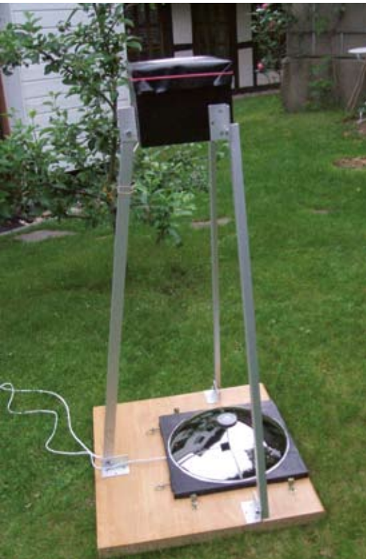
Die von der Autorin konstruierte und selbst gebaute Meteorkamera besteht aus einem Parabolspiegel, über dem eine Spiegelreflexkamera aufgehängt ist. Diese befindet sich in dem schwarzen Gehäuse oben.
